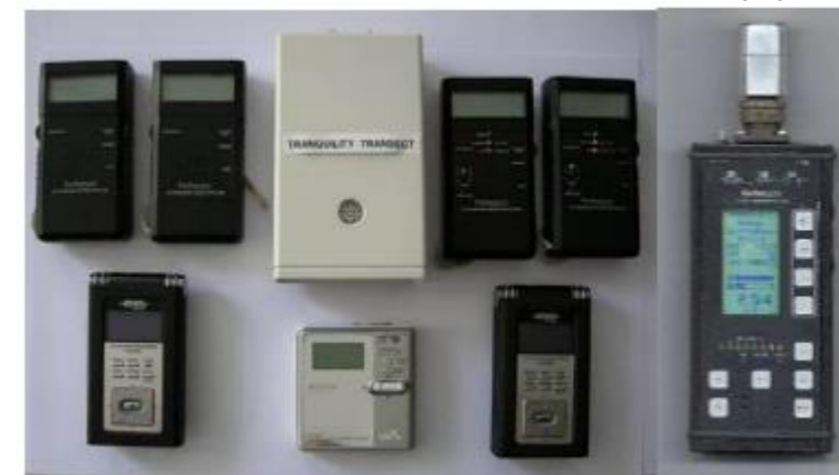
Figure 9 : Détecteurs d'ultrasons et enregistreurs numériques utilisés lors de l'étude (IEA)
